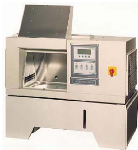
Solarbox 1500e с системой орошения
