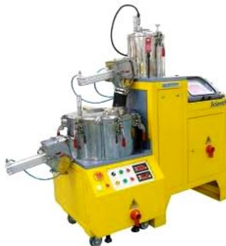
Высокоскоростной смеситель объемом 5 литров и охлаждающий смеситель объемом 12 литров
