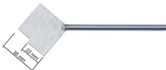
Инструмент для измерения и настройки конуса пламени (примерно 22 мм) и высоты пламени (примерно 38 мм).
